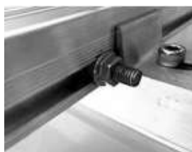
Dispositif anti-glissement pour le climber 36/50
